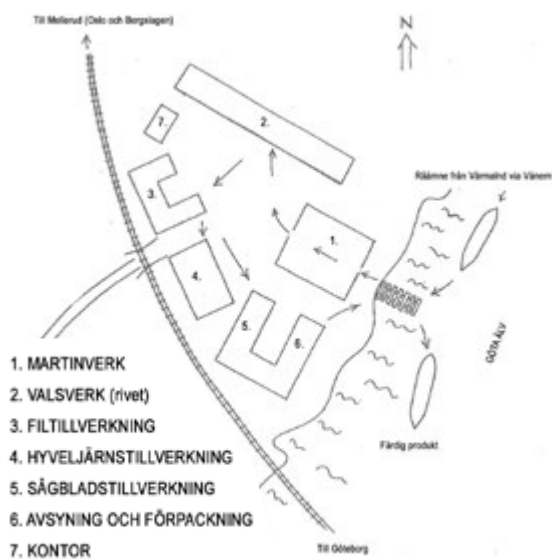
Till vänster: Illustration av transportgången från råämne till färdig produkt på Stridsberg och Biörck. Till höger: Foto över Stridsberg och Biörck, foto från Vänerflyg.
