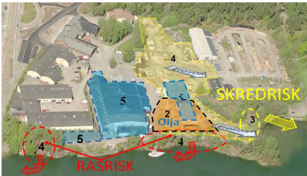
Sammanfattande riskbild på Källstorps industriområde, s. 9 i utredningen Hantering av förorenad mark och byggnader vid framtida exploatering av Källstorps industriområde för bostäder m m
